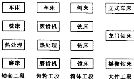
图 1-5 机床设备布置的对象专业化原则
