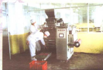
冲剂车间铝箔自动包装机
