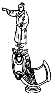
圖5 手指中插有磁石的偶像 裝在中國車上借以指示南方
