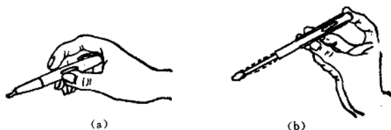
图 2-2 低压测电笔的握法
