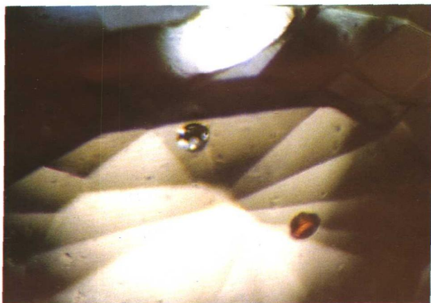
斯里兰卡蓝宝石中的金红石和圆形气泡(25×) (气泡明亮、壁薄)
