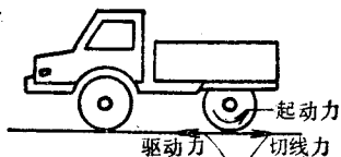
图1 行驶原理示意图
