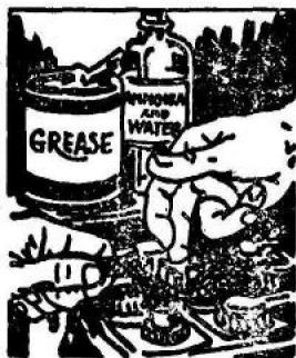
圖 4 線端要塗抹潤滑油膏。
