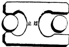
圖10 使用卡規檢驗軸徑的情況——過小。
