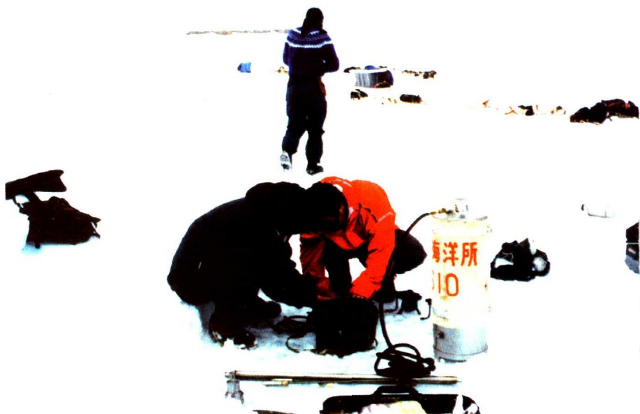
▲用蒸气钻穿冰面,进行物理海洋测试。
