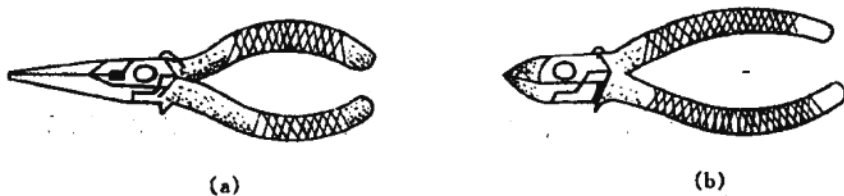
图 1-3 花样钳 (a) 尖嘴钳；(b) 斜口钳
