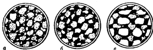
圖 2-3 砂輪的組織 \alpha —稠密 \beta —中等 \epsilon —稀疏
