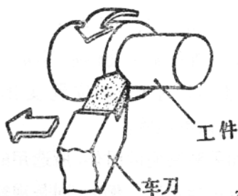
图 1-1 车床上车刀的平动和工件的转动
