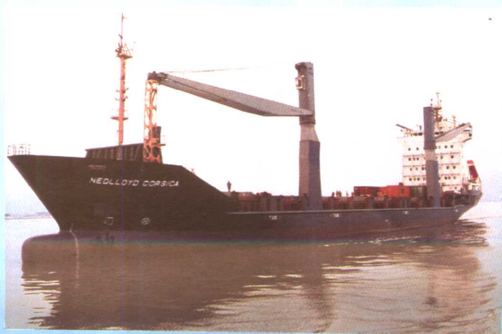
▷ 最新研制出口的悬挂德国国旗的 660箱多用途集装箱货船
