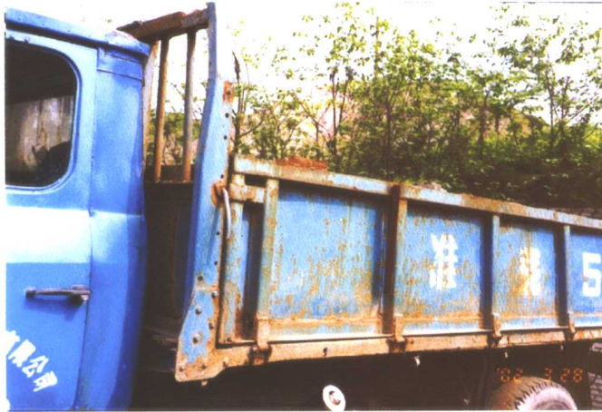
图 3.8.18 车厢、驾驶室的腐蚀 (116 页)
