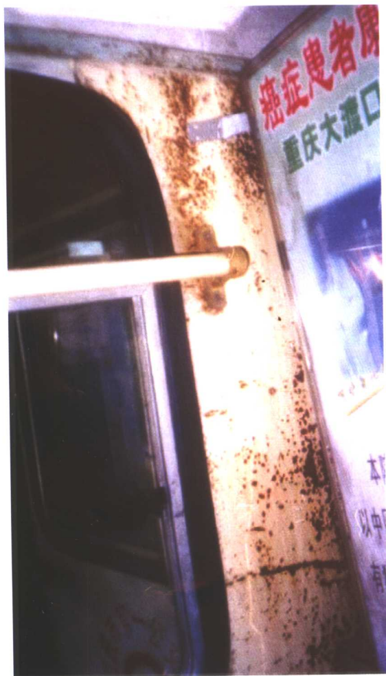
图3.8.5 车厢内面板的腐蚀 (115页)
