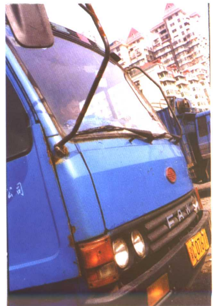
图 3.8.20 车门、车前面板、反光镜支架 等的腐蚀 (117 页)
