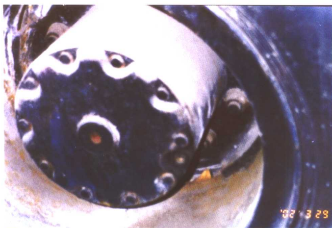
图 3.8.24 车轮轮辋的腐蚀 (117 页)
