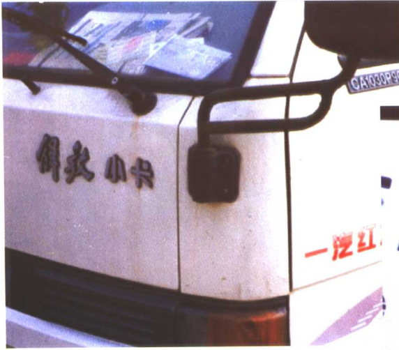
图 3.8.13 车门、反光镜支架、雨刮座的腐蚀 (116 页)
