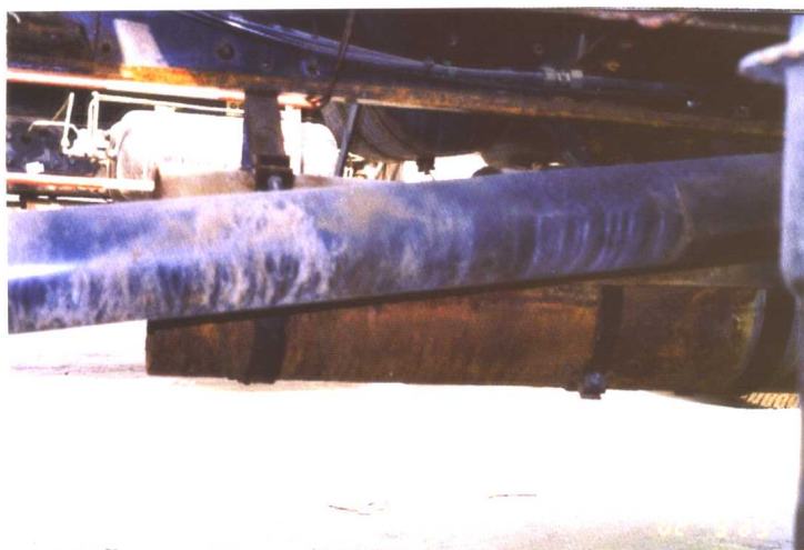
图3.8.22 传动轴、梁、消声器等的腐蚀 (117页)
