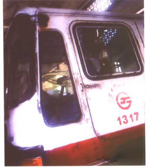
图 3.8.2 前反光镜支架、面板连接处、车门、车门框、面板的腐蚀 (115 页)
