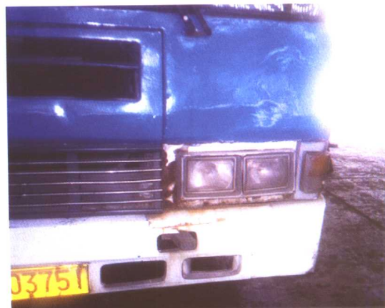
图3.8.7 车灯框的腐蚀的放大图 (115页)
