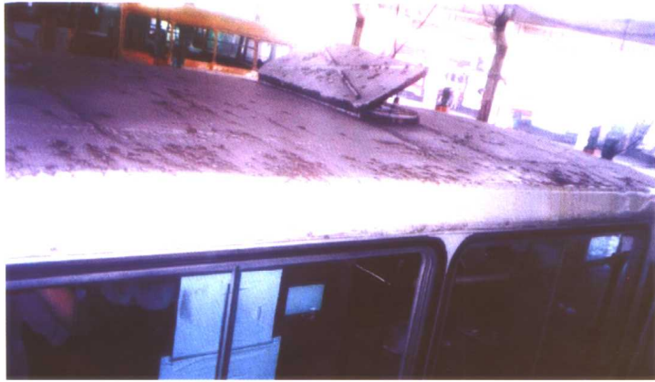
图 3.8.9 车顶的腐蚀情况 (115 页)
