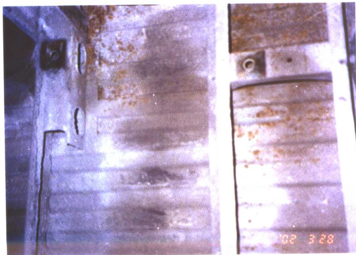
图 3.8.16 车厢底的腐蚀 (116 页)
