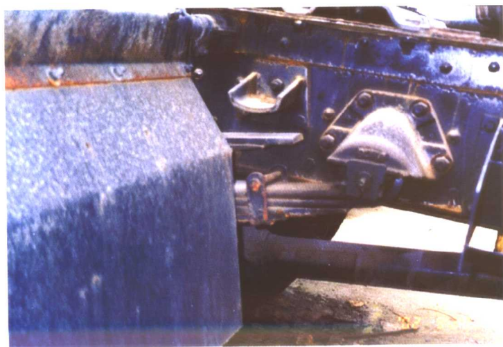
图3.8.23 大梁、板簧、车轮罩等的腐蚀 (117页)
