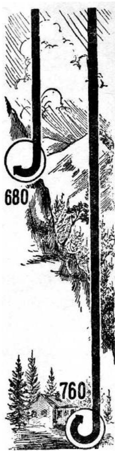
圖3. 空氣壓力隨高度上昇而下降（圖中的數字是壓力的毫米數）
