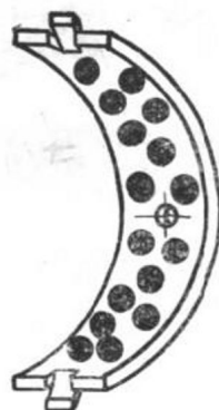
图1-3 斜盘摆轴轴瓦结构示意图
