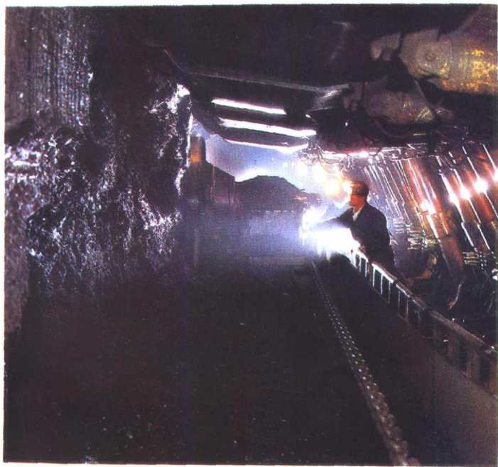
年产百万吨的综合机械化采煤机
