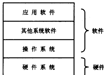
图 1.3 计算机系统的层次结构
