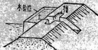
图4 做围堰处理横向裂缝
