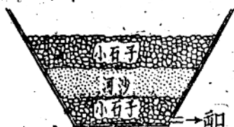
圖4 過濾池的簡單構造
