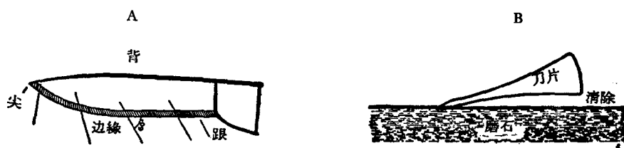
图8 表示刀口被磨区的范围为1毫米深
