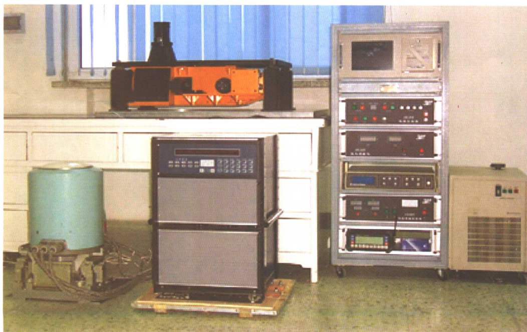
彩图 2 线扫描、八波段激光三维遥感集成系统的遥感器
