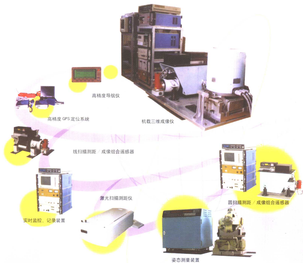
彩图 1 圆扫描激光三维遥感集成系统的遥感器
