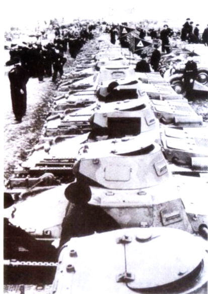
▲ 1935年野外训练中I号坦克A型队列。从第2辆车上可以清晰的观察到RAL8002黄褐色、RAL8010褐色、RAL6007绿色的三色迷彩涂装中的各色块
