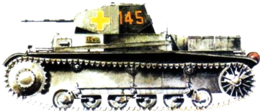
安装旧式摇臂式行走装置的II号坦克B型。该坦克为1939年9月参加波兰战役的德国第4装甲师所属车辆，该部队在围攻华沙的战斗中遭到波兰反坦克炮兵的猛烈打击。
