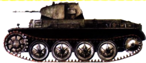
II号坦克D型炮塔采用重新设计的车体布局，配以新式扭杆悬挂系统。II号坦克D型和派生型的E型只参加了1939年波兰战役，其后被改造为喷火坦克服役。本车为试制样车，在深灰的车体上尚未涂绘各种标志。
