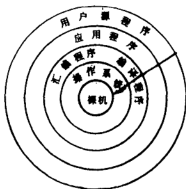
图 1-3 计算机软、硬件的层次
