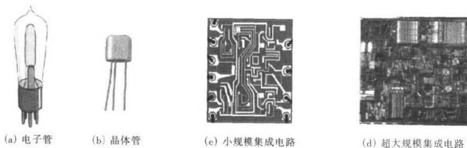
图 1-3 电子管、晶体管与集成电路
