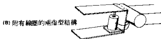
圖 1—1 Unimate 機械人的簡易手部設計
