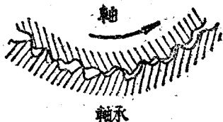
圖1 加工面上的顯微不平度
