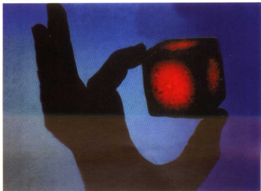
隔热性能极佳的陶瓷， 即使中心部分温度很高， 还是可以用手拿
