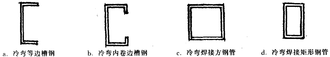
图 1-1-9 冷弯薄壁型钢断面图
