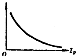
图1-2 电力方向继电器的伏安特性曲线
