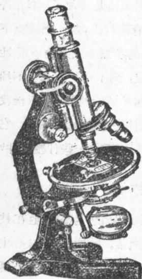
圖2 顯微鏡。在它的鏡台上放着載玻片，由二個彈簧夾固定。在載玻片中央，圓形蓋玻片下面的是被觀察的東西。
