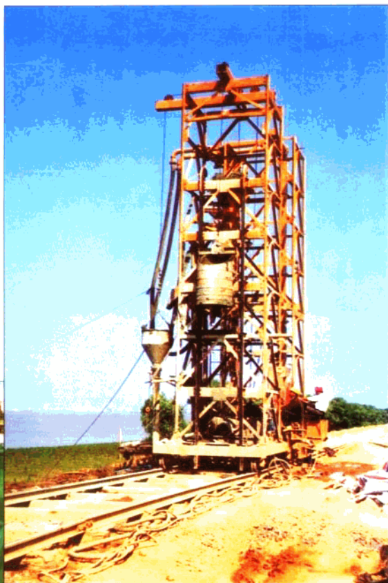
射水法造墙机 — 获1992年国家科技进步三等奖
