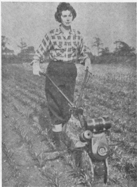
图 4 耕耘机在耕作，图中所示机体窄小，易于在行间穿过
