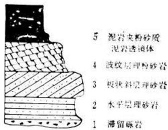
图 1-1 四川中江继光水库高弯度河流形成的正向半韵律旋回典型剖面图
