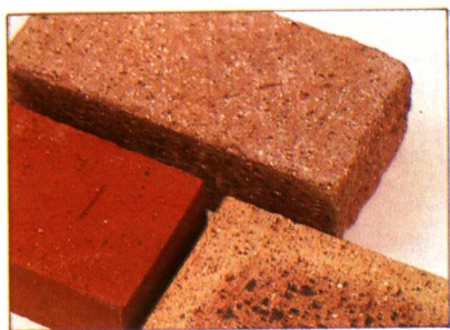
粘土砖: 自然土色,给人以亲切感,具有杰出的耐久性和耐火性。
