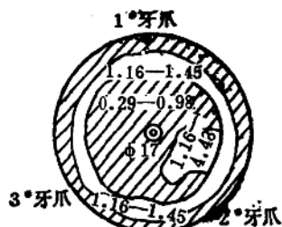
图 11 \phi 17 扩散式中心喷嘴
