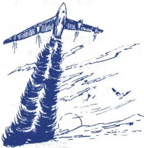
波音 B-47 远程重型轰炸机用助推火箭加速起飞
