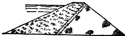
圖 13 混合壩(斜牆用土料)
