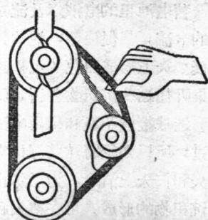
这条皮带还带动着固定在发动机旁边的发电机。松卸发电机前端的螺栓和螺帽，然后把发电机向发动机推去或向外拉开，就可以调整皮带而得到正确的松紧度。调整后，必须旋紧螺栓和螺帽。
