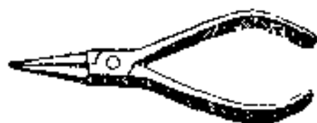
直嘴式孔用挡圈钳
