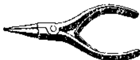
直嘴式轴用挡圈钳
