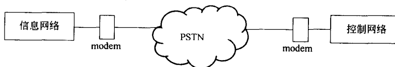
图 1.4 利用 modem 数据通信实现控制网络与信息网络集成
