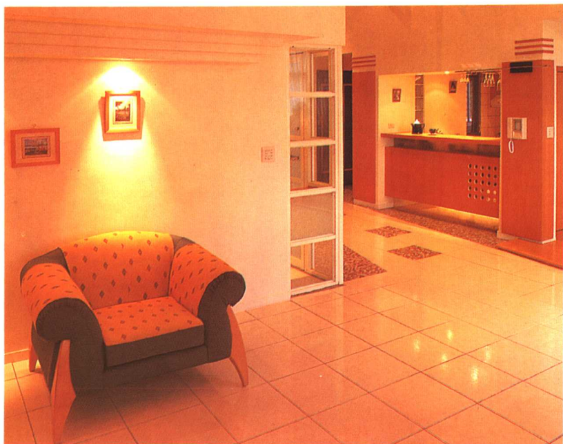
▲天花:仿瓷涂料;墙面:仿瓷涂料;地面:瓷砖、马赛克
