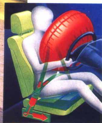
安全气囊能在1/100秒的时间 内充气膨胀,以保护驾车者
