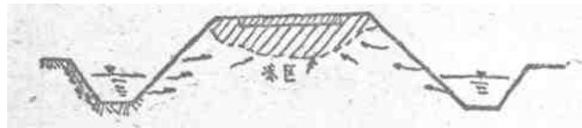
图9 表面水引起内部翻浆
