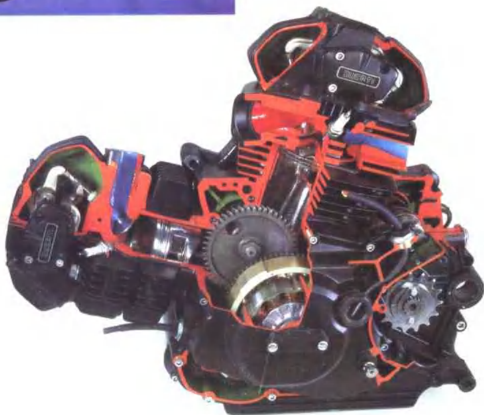
彩图 7 杜卡迪 350F 发动机剖示图
