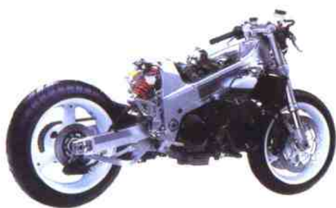
② 除去护板、油箱和车座的状况
