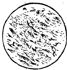
看去很光滑的金屬板(上)， 在顯微鏡下面看，就處處都 像山谷，凹凸不平(下)
