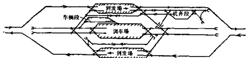
图3 编组站布置图中的非机械化驼峰位置图
