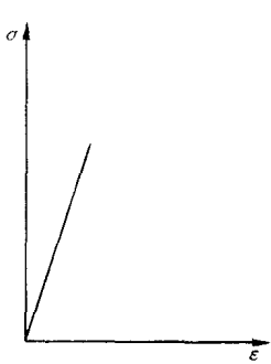
图 1-2 玻璃纤维拉伸应力应变关系
