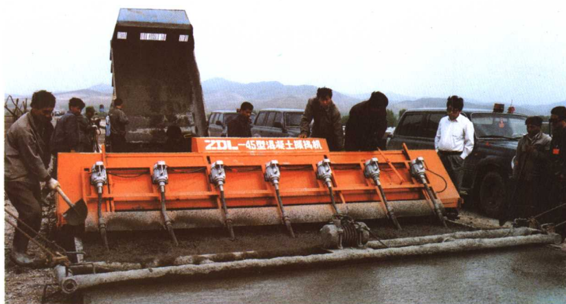
②⑥施工单位自行研制的混凝土振捣机
