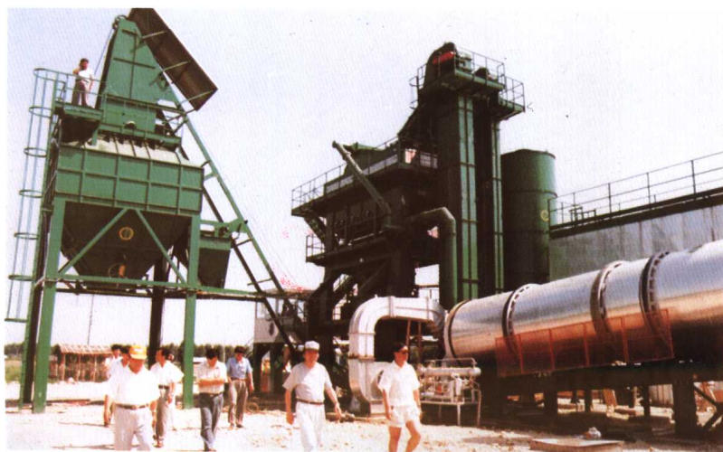
②④从意大利引进的伯纳第大型沥青混凝土拌和站
