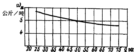
图 I—1 单位基本阻力取决于车辆重量的关系曲线
